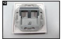
Montieren Sie das Rahmenset bestehend aus Modulträger und Abdeckung. Assemble the metal frame and the coverplate.
