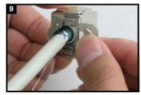
Die 180°Schirmschelle aufsetzen. Install the 180° shielding clamp.
