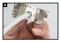
Den Sortierer in Pfeilrichtung in das Modul einsetzen. Bitte Pfeilrichtung beachten! Install the termination cap in direction of arrow into the Keystone Jack.
