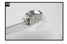
Das Modul mit dem Kabelbinder zugentlasten und die Schirmschelle fixieren.
