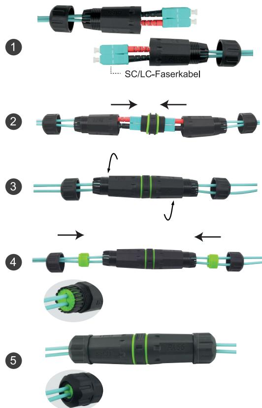
Führen Sie die beiden Patchkabel durch die Endabdeckungen und dann durch die Gehäuse.
